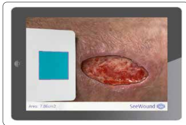
Figur 1c: Sårkanterna markeras automatiskt (svart) och SeeWound återger en storleksuppskattning av sårets yta (7.86 cm 2 ) direkt vid vårdtillfället.
